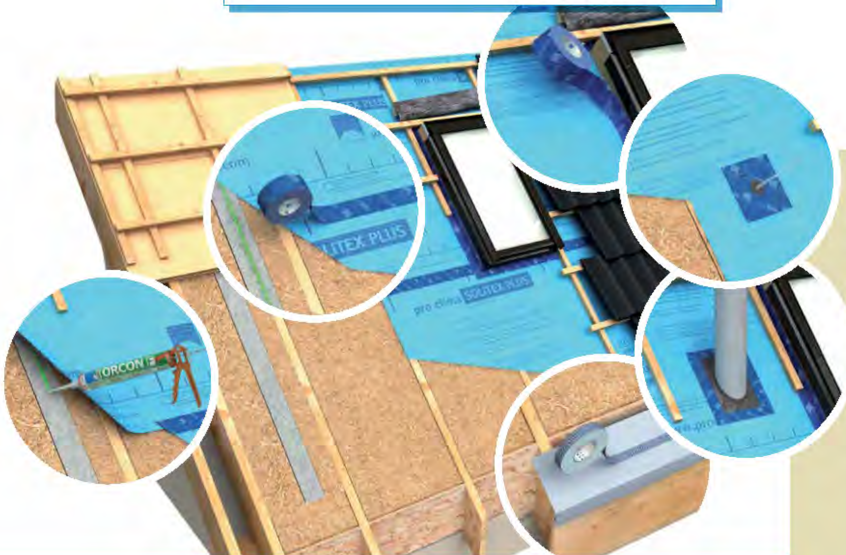
TESCON PROFIL K napojení na okna, dveře a rohové spoje
