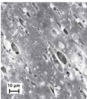
Mikroskopische Aufnahme einer herkömmlichen Unterdeckbahn. Poröse Bahnen lassen Feuchte durch Strömung entweichen. Sie bieten durch die Poren nur durchschnittliche Sicherheiten bei Diffusion und Schlagregendichtheit.
