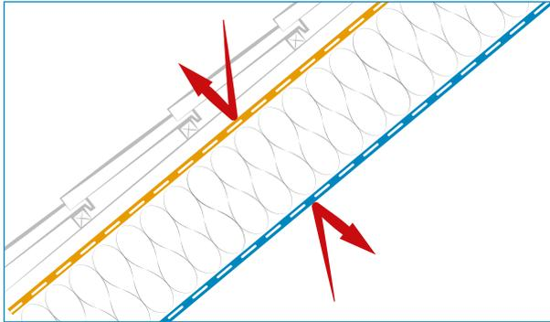
Die Wirkung aller Wärmedämmungen beruht auf den Luftporen im Dämmmaterial (Zellulose, Kork, Woll-, Holz-, Mineralfasern oder andere Materialien). Voraussetzung für die dämmende Wirkung dieser Luftporen ist deren Schutz vor Luftbewegung. Deshalb ist bei der idealen Dämmkonstruktion der Dämmstoff allseitig abgeschlossen: innen luftdicht - außen winddicht.
