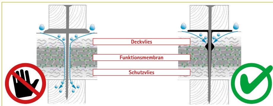
Nageldichtungen auf Schaumbasis dichten nur auf dem Vlies ab – Wasser im oberen wasserführenden Vlies kann durch die Durchdringung der Membran eindringen. Die Konstruktion kann so feucht werden und Schaden nehmen.
