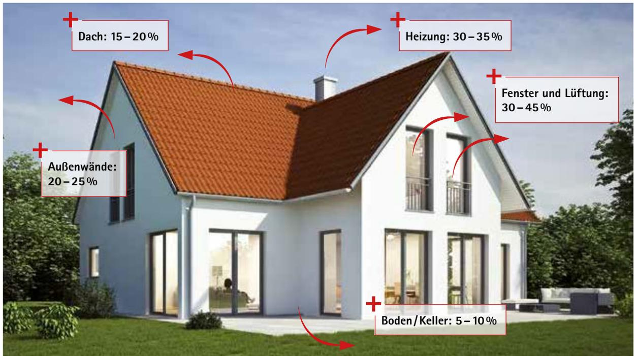
Eine undichte und unzureichend gedämmte Gebäudehülle führt zu Wärme- und damit zu Energieverlusten. Fenster und Türen, mit deren fachgerechtem Einbau, haben darauf einen sehr großen Einfluss. Dieses Beispiel zeigt das an einem freistehenden Einfamilienhaus, Baujahr 1984. (Quelle: saena)
