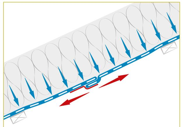
Lastbeispiel Bahnenüberlappung: Klebeband wird auf Abscheren beansprucht. Zu weich eingestellte Klebebänder versagen hier.
