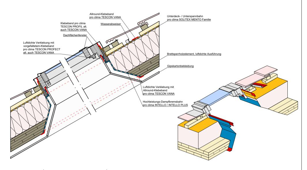
Holzmassivbau Fensteranschluss Dachflächenfenster Var. 1
